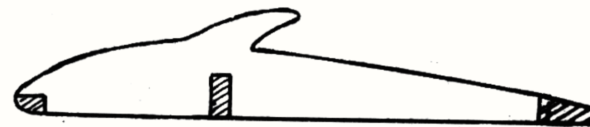
Nervura centrală stabilizator placaj 1mm.
